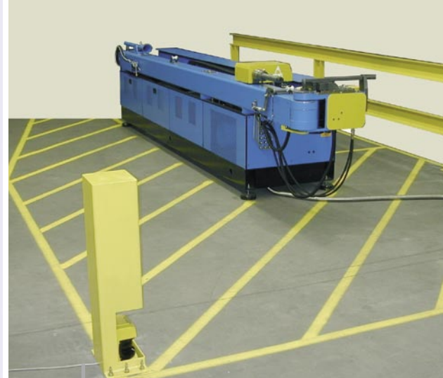
Absicherung des Biegebereiches (hier z. B. durch Flächenscanner realisiert).
