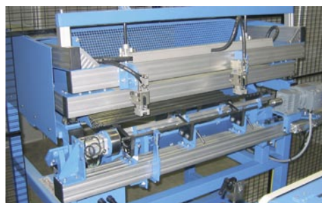
Rohrmagazin mit Vereinzlung und Zuführeinheit.
