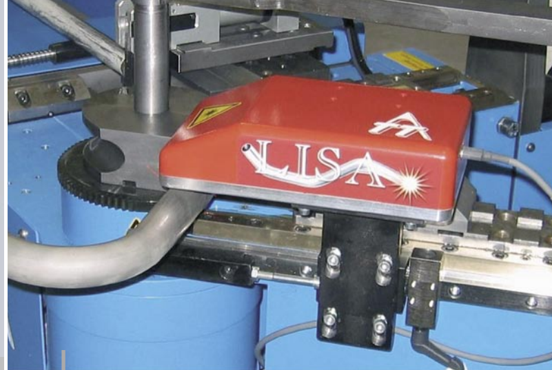
Mit LISA kann das Biegeergebnis „online“ ermittelt und dokumentiert werden.
